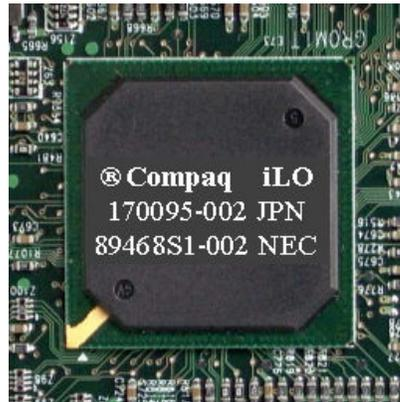
iLO は、主要なサーバのシステムボードに組み込まれている ASIC です。iLO は、インテリジェントなプロセッサとファームウェアで構成され、標準および高レベルの Lights-Out 機能を提供します。
