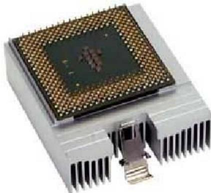
ヒートシンクに取り付けられた FC-PGA2 プロセッサ (底面)
