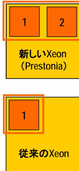
Intel Xeon や一部の Pentium 4 プロセッサには、1つのコア上に2つのレジスタのセット(アーキテクチャステート)があります。これにより、各物理プロセッサは、2つの論理プロセッサとして機能することができます。コア内の実行ユニットおよびその他のリソースは2つのアーキテクチャステートによって共有されるため、実行ユニットはより頻繁に活用されるようになります。この結果、ハイパースレッディング テクノロジを使用しているプロセッサは、このテクノロジーを使用していないプロセッサと比較して、約30%の性能向上を達成することができます。
