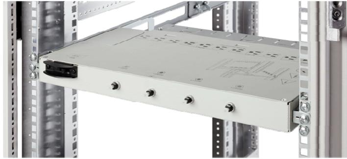
PDU は、1 つの電源から複数のオブジェクトに電力を供給します。ラックマウント環境の場合、PDU は、サーバ、ストレージ、および他の周辺機器に電力を分配します。
