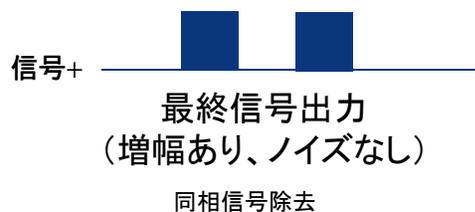
ディファレンシャル SCSI バスは、SCSI-2 標準で初めて採用され、バス長の制限による潜在的なボトルネックを軽減します。
