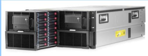
D6020 の片側のハードディスク ドロアーを引き出した状態
