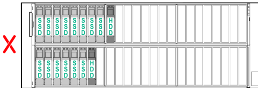
図 13: 4 ノードエンクロージャー内でのアンバランスな SFF (2.5 型) ドライブ割り当ての例
