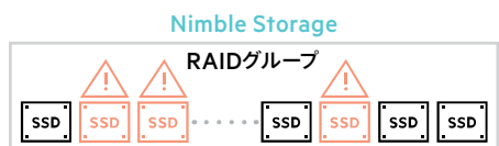
1つのRAIDグループでディスクが3本壊れてもデータを保護
