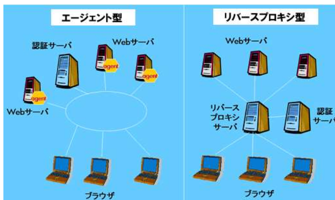
図1 エージェントモジュール型とリバースプロキシ型の概要
