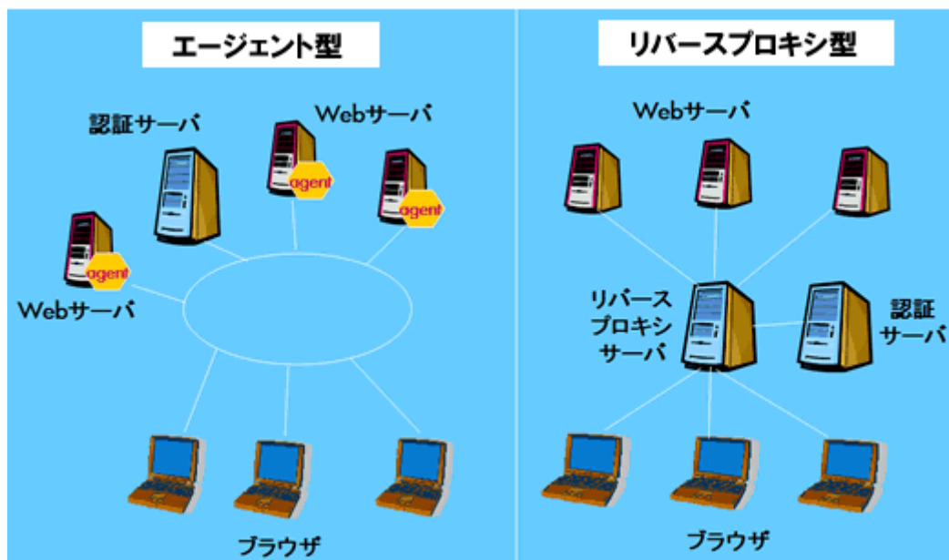
図1 エージェントモジュール型とリバースプロキシ型の概要
