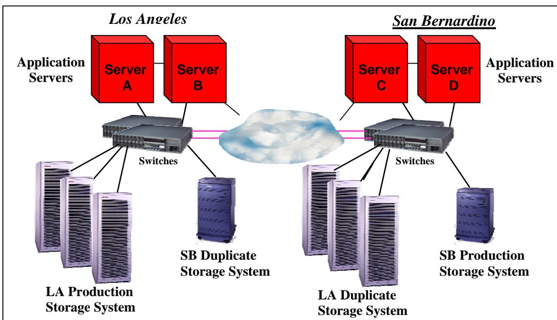
システム・ベースのデータ高可用性機能の場合も、StorageWorks Continuous Access の場合も、複製されるデータは、システムまたはストレージ・コントローラによって複数回書き込まれます。そして、ソース・ディスク上のすべてのデータが、ミッション・クリティカルなデータベース・ファイルであれ、一時領域に書かれた一時ファイルであれ、ターゲット・ディスクに書き込まれます。したがって、必要なもの (たとえば、データベース・ファイルに含まれておらず、おそらく同じディスク・ボリューム上にもないデータベース・アプリケーションのための起動スクリプトなども忘れず) をすべて複製する一方で、余計なもの (/tmp など) は複製しないように、慎重に計画する必要があります。
