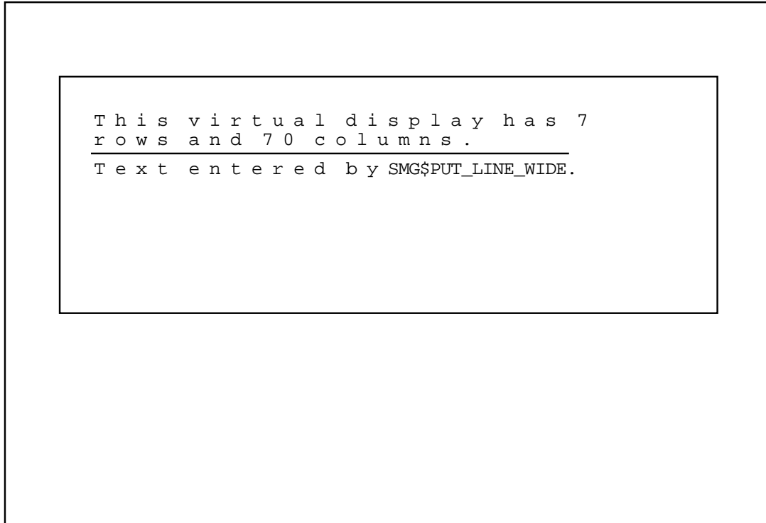
図 8-32 SMG$PUT_LINE_WIDE を呼び出す FORTRAN プログラムによって生成される出力
