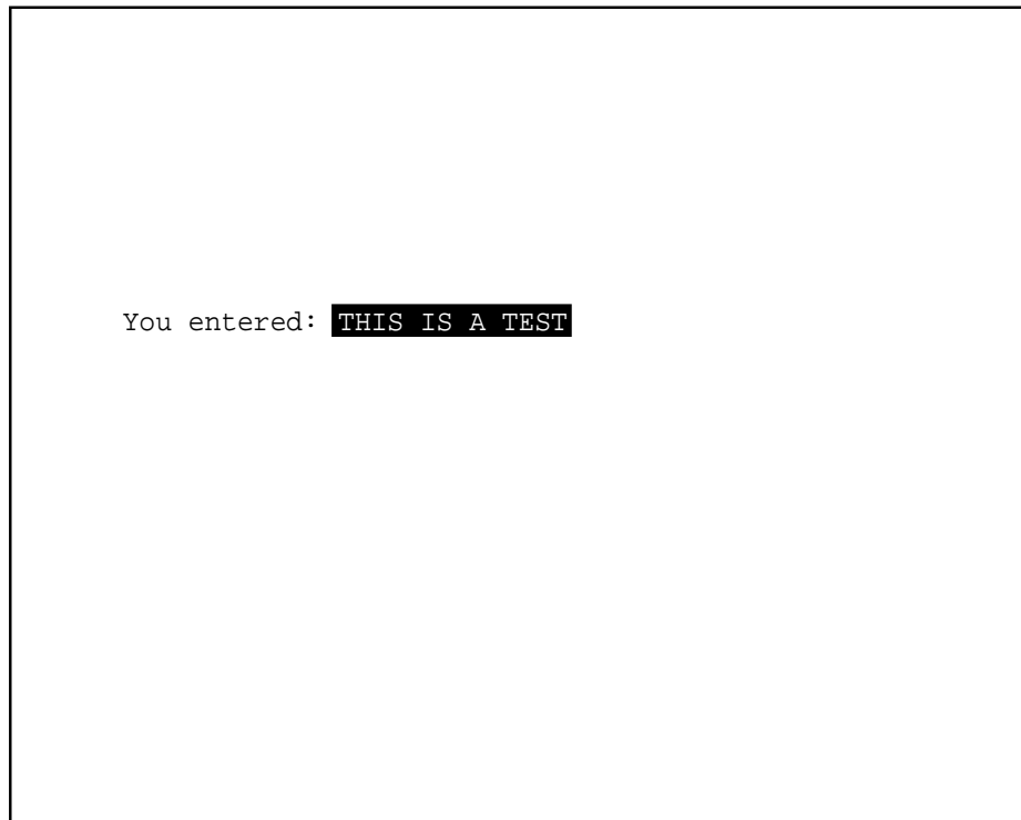
図 8-9 SMG$CREATE_VIRTUAL_DISPLAY ルーチン呼び出す FORTRAN のプログラムが生成する出力
