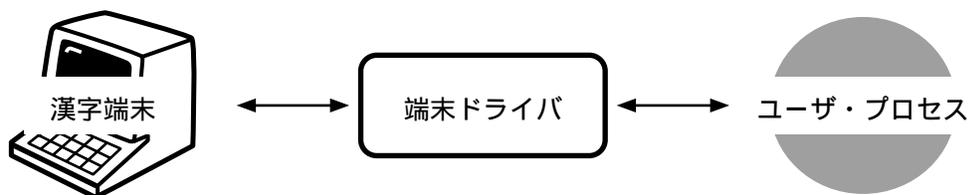
FIP/SUB を使用する場合は、端末ドライバとユーザ・プロセスの間に FIP/SUB プロセスと疑似端末ドライバが加わります。ユーザ・プロセスは FIP/SUB のサブプロセスとして作成され、ユーザの実行するコマンド/プログラムはすべて、このサブプロセスの中で実行されます。端末に対する入出力は FIP/SUB と疑似端末ド
