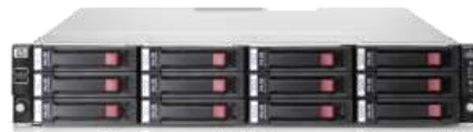
図 4. HP ProLiant DL180G6 は2U で内蔵ディスク 42TB の容量を持つ
