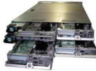
図 2. HP ProLiant DL2000 は2U で4ノードが稼働する高密度サーバー
