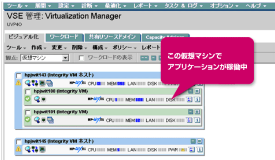
図 3 : Virtualization Manager 上でホスト OS とゲスト OS を表示した例
