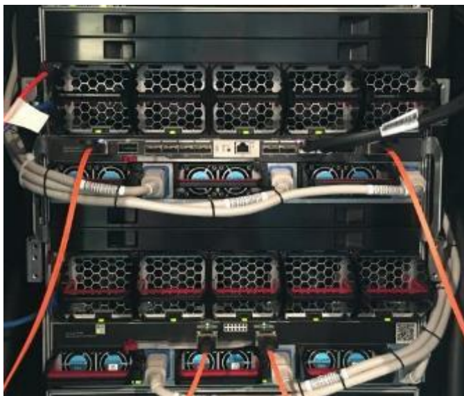
集約の効果により、一切冷却を妨げないケーブル配線
