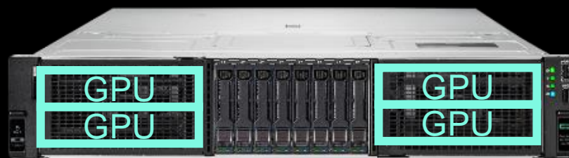
ダブルワイドGPUを4枚搭載(DL380a, DL385 Gen11)
