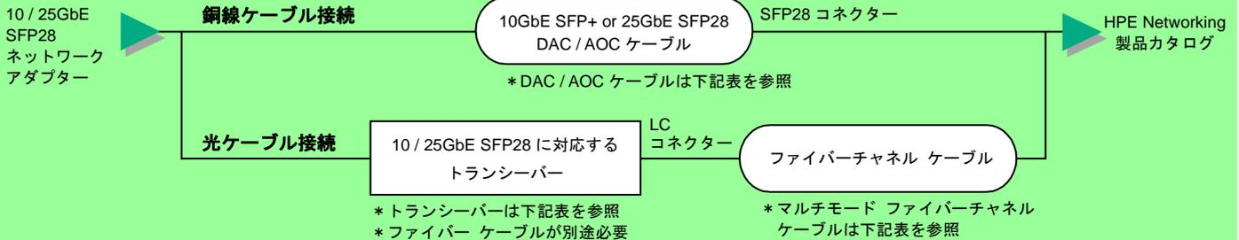
下記対応表を参照し、OCP および PCI Express の 25GbE SFP28 NIC でサポートする長さの DAC / AOC ケーブル、トランシーバーを選択ください。
