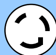
左図：UPS R5000 G2 の入力電源プラグの形状 ツイストロック コネクター【NEMA L6-30P】 (NEMA L6-30P と NEMA L5-30P は プラグの大きさが異なります)
