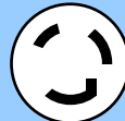
左図：UPS R5000 G2の入力電源プラグの形状 ツイストロック コネクター【NEMA L6-30P】 (NEMA L6-30P と NEMA L5-30P は プラグの大きさが異なります)
