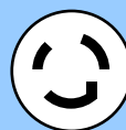
左図：UPS R/T3000 G5 (200V) の 入力電源プラグの形状 ツイストロック コネクター 【NEMA L6-20P】
