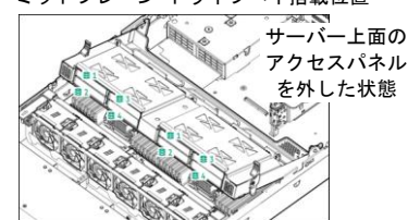
ミッドプレーン ドライブベイ搭載位置
