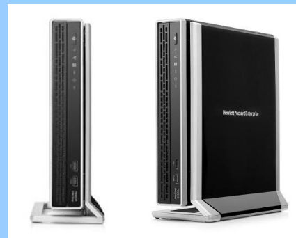
TM200 スタンド キットに装着した ProLiant Thin Micro TM200 Server
