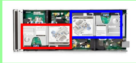
赤枠部分と青枠部分にダブル ワイド GPU を 1 枚ずつ計 2 枚搭載可能
