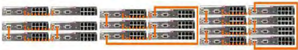
複数のイーサネット タイプの VC モジュールのスタッキングリンク接続例
