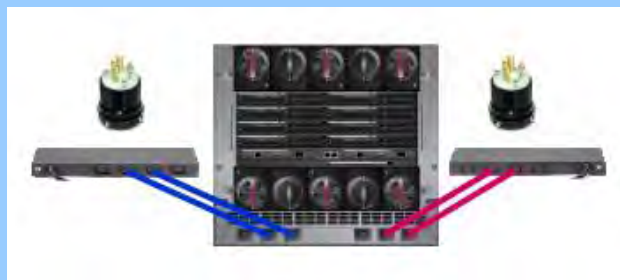
BladeSystem c7000 エンクロージャーと 200V-24A PDU の配線例
