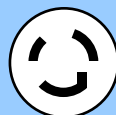
200V 電源コードオプションの入力電源プラグの形状 ツイストロック コネクター【NEMA L6-20P】
