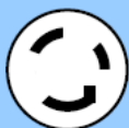
100V-24A bPDU の 入力電源プラグの形状 ツイストロック コネクター 【NEMA L5-30P】
