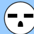
200V 電源コード オプション キットの入力電源プラグ形状 【NEMA 6-15P】
