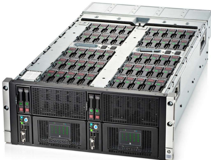
図 1. HP ProLiant SL4540 Gen8 サーバー(2 ノード構成で、上部カバーを取り外した状態)
