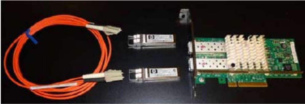
図 2: PCIe NIC、SFP+モジュール、およびファイバーケーブルの取り付け
