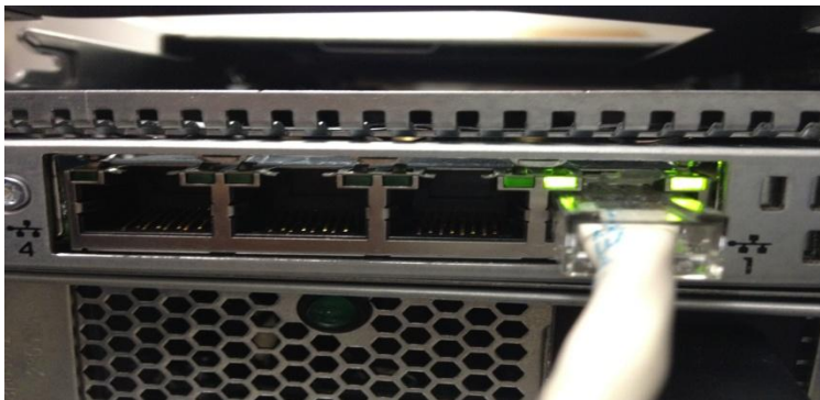
図 1: ProLiant DL360p Gen8 サーバーのクアドポート LOM - ポートは右から左の順にラベル付けされている
