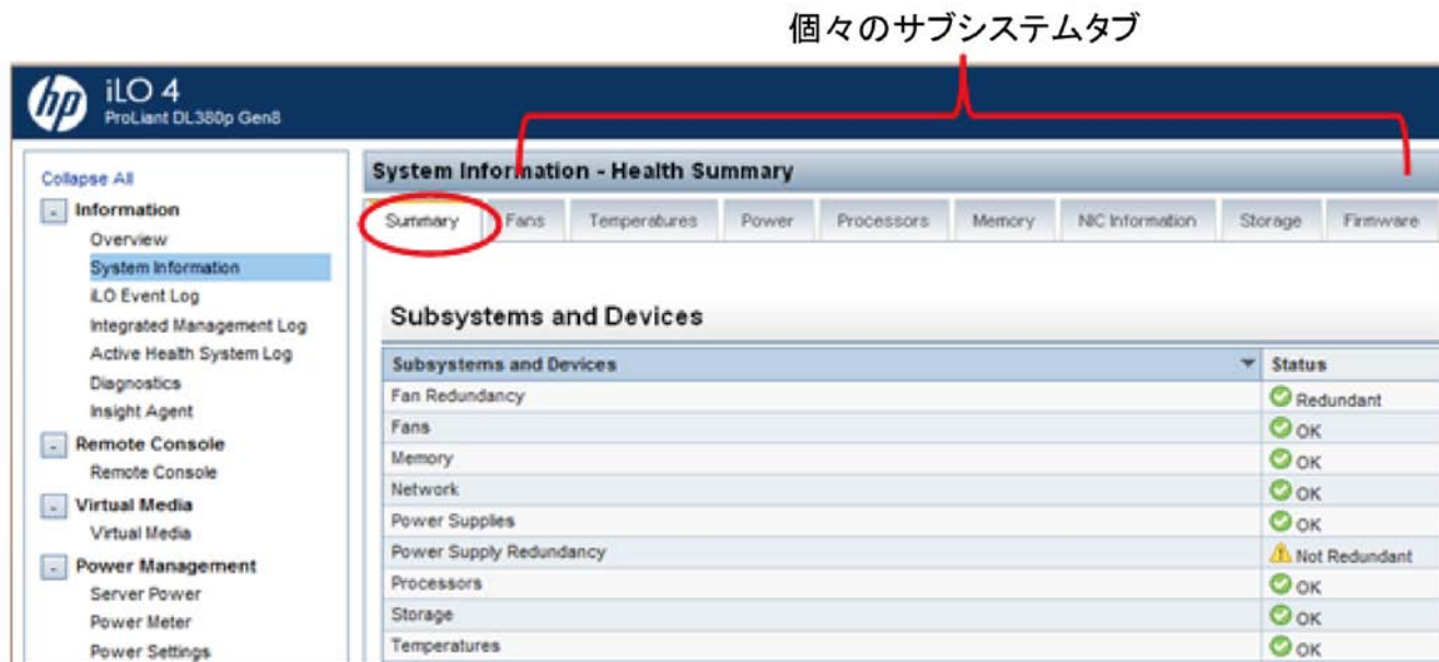
図 3: 稼働状況の概要情報タブを示すスクリーンショット - 他のタブにも詳細情報が表示される
