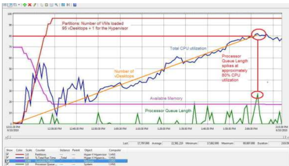
図5: 80個の仮想デスクトップがアクティブなときにプロセッサキューが繰り返しピークに到達(利用率の最初のピークは仮想デスクトップの起動によるもの)
