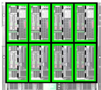
テープブレードとハーフハイト ブレードの 接続される隣接ベイ (緑枠内の左右逆も可) 上図は c7000 エンクロージャーの場合
