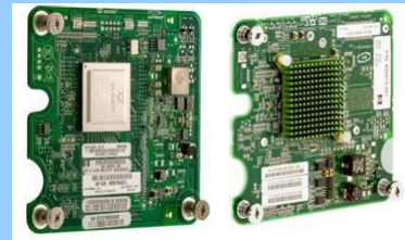
8Gb デュアルポート ファイバーチャネル ホスト バス アダプター メザニン カード QLogic QMH2562 (左)、Emulex LPe1205 (右)
