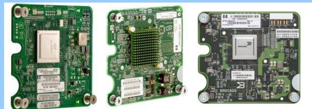
8Gb デュアルポート ファイバーチャネル ホスト バス アダプター メザニン カード QLogic QMH2562 (左)、Emulex LPe1205 (中)、Brocade 804 (右)
