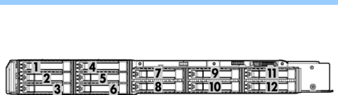
HP D2200sb ストレージブレードのハードディスク ドライブ ドロワーのドライブ ベイ番号 (ドライブはベイ番号の小さい順に搭載してください)
