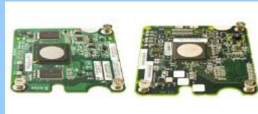
4Gb デュアルポート ファイバーチャネル ホスト バス アダプター メザニン カード QLogic QMH2462 (左)と Emulex LPe1105 (右)
