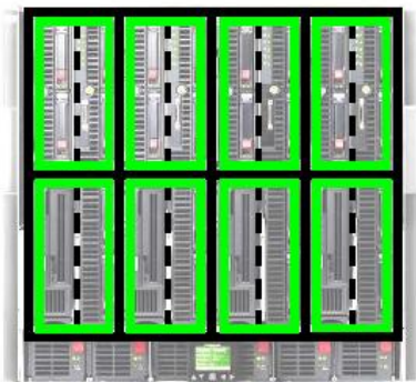
テープブレードとハーフハイト サーバードライブの接続される隣接ベイ (緑枠内の左右逆も可) 上図は c7000 エンクロージャーの場合
